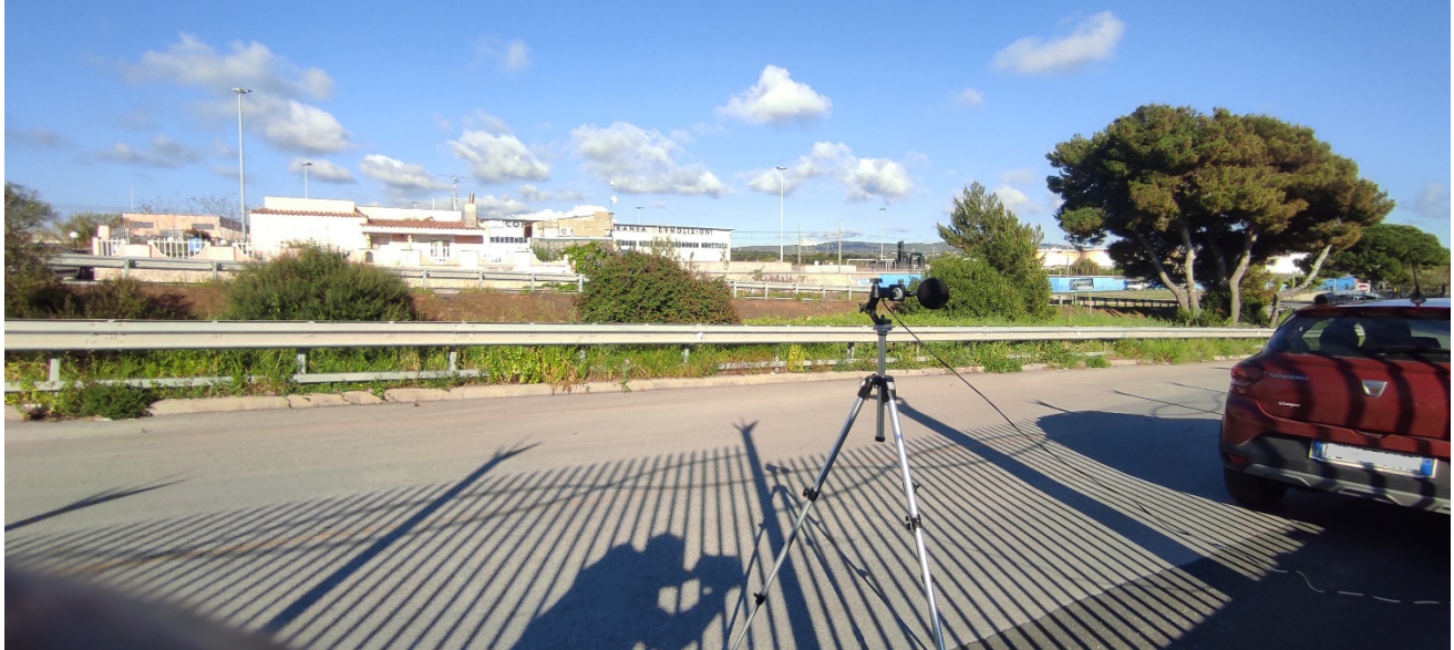
Fonometro collocato sulla strada limitrofa, a circa 35 metri dalla facciata dell'abitazione.
